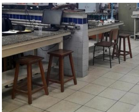
Figura 48 - Imagem interna do laboratório sem mobiliário acessível, bancadas altas e banquetas não acessíveis
